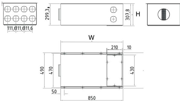
Sagome dei pre-trancianti atte ad accogliere le partenze collettore cod. 5091 (escluse dalla fornitura del plenum) di modo da poter staccare sia con tubo DN75 che con tubo DN90.
