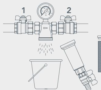
**N.B.:** Au cours de cette opération les vannes d'arrêt 1 et 2 doivent être ouvertes.
