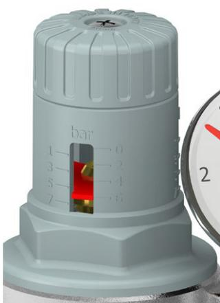
La taratura finale del riduttore di pressione deve essere eseguita a circuito idraulico completamente pieno e con tutti gli utilizzi chiusi, diversamente si avrebbero dei valori falsati dal fatto che, durante l'eventuale erogazione, la pressione a valle diminuisce in relazione alla quantità di flusso occorrente.
