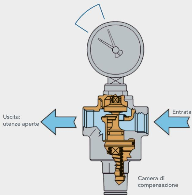
Con l'apertura delle utenze a valle, la pressione esercitata sul pistone viene meno a favore della forza esercitata della molla sull'otturatore, permettendone l'apertura con il conseguente transito di fluido. Più alta è la richiesta d'acqua da parte della rete d'utenza, più diminuisce la pressione sul pistone e maggiore sarà il passaggio d'acqua.
