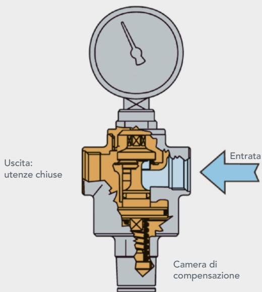
Quando le utenze da servire sono chiuse, la pressione a valle aumenta, spingendo il pistone del riduttore verso il basso. In questo modo l'otturatore chiude la sezione di passaggio del riduttore, mantenendo costante la pressione al valore di taratura impostato sulla molla. La minima differenza di pressione esistente a cavallo dell'otturatore consente, infatti, la perfetta chiusura di quest'ultimo.
