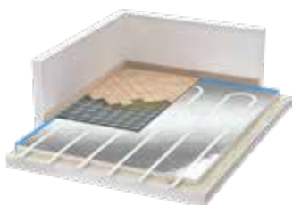
Posa parquet incollato
