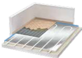
Pose de parquet collé
