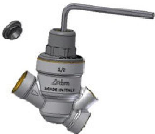
La taratura finale del riduttore di pressione deve essere eseguita a circuito idraulico completamente pieno e con tutti gli utilizzi chiusi, diversamente si avrebbero dei valori falsati dal fatto che, durante l'eventuale erogazione, la pressione a valle diminuisce in relazione alla quantità di flusso occorrente.
